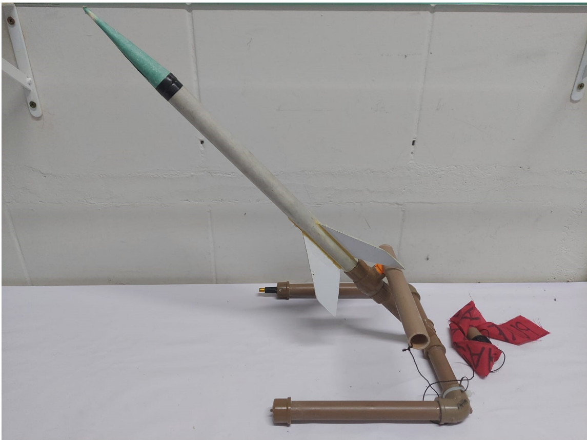
A foto acima mostra o foguete de papel já posicionado ao redor do tubo de lançamento. Ao se pressurizar a base com uma bomba de encher pneu de bicicleta e puxar o gatilho, o foguete será lançado ao espaço.
