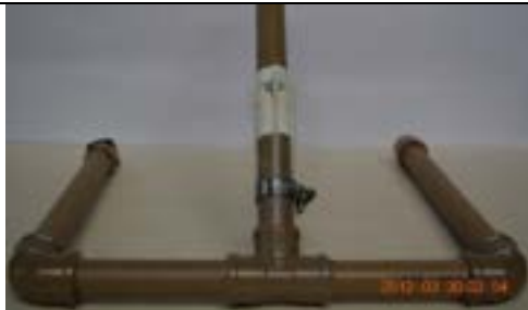
Fig. 16. Base com as 4 abraçadeiras de nylon presas com a abraçadeira de metal. Use 8 abraçadeiras!
